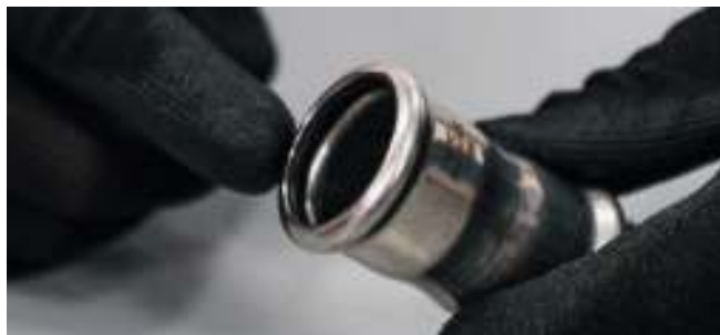
Рис. 30. Проверка уплотнительного кольца.
